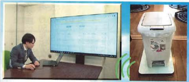
ごみ箱の下にIoTにつながった体重計を敷くだけで計測が可能
